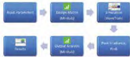
Σχήμα 9. Διαδικασία Πειραματικού Σχεδιασμού. Το ειδικό λογισμικό στατιστικής ανάλυσης (Minitab) χρησιμοποιήθηκε για την δημιουργία των δεδομένων εισόδου της προσομοίωσης καθώς και ανάλυσης των αποτελεσμάτων, ενώ ο κώδικας WaveTrain χρησιμοποιήθηκε για την προσομοίωση της διάδοσης της δέσμης του λέιζερ στην ατμόσφαιρα. Lionis (2016).
