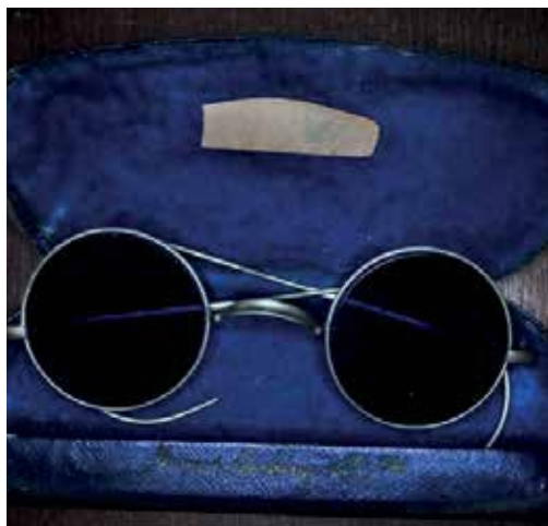
Ματογυάλια πυρακτώσεως, για προστασία κατά την αφή του φάρου, Πηγή: Υπηρεσία Φάρων, κ.κ.
