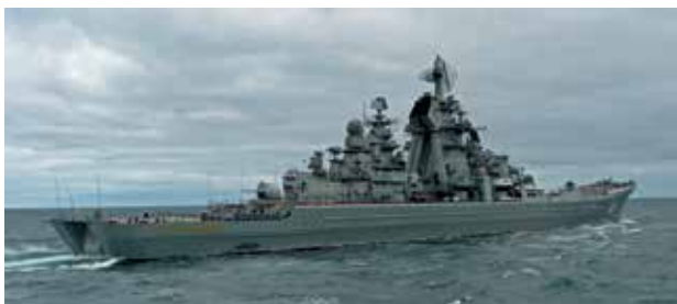
Το πυρηνικό καταδρομικό κατευθυνόμενων βλημάτων Kiron έχει μήκος 248 μέτρα, εκτόπισμα 28.000 τόννους, διαθέτει 96 κάθετους εκτοξευτές αντιαεροπορικών πυραύλων SA-N-6, 48 αντιαεροπορικούς πυραύλους SA-N-20 και 20 εκτοξευτές πυραύλων επιφανείας-επιφανείας SS-N-19, 8 συστήματα CIWS Gatling για εγγύς προστασία.
