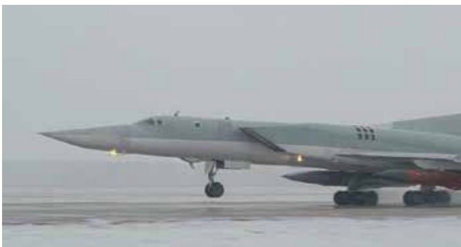
Το στρατηγικό βομβαρδιστικό Tu-22M Backfire C έχει αυξημένο ρόλο ναυτικής κρούσης. Το πλήρωμα του είναι τέσσερα άτομα, είναι συνήθως εξοπλισμένο με δύο πυραύλους Kh-22 αρχικής ταχύτητας Mach 3 και τελικής Mach 4,5 με αποτέλεσμα να είναι πρακτικά αδύνατο να αντιμετωπισθούν από οποιοδήποτε δυτικό σύστημα CIWS.
