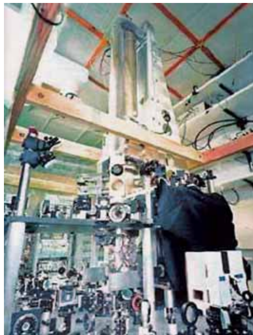
Εικόνα 10. Ατομικό ρολόι καισίου. Ο ακριβέστερος ωρολογιακός μηχανισμός του κόσμου (Μπόλντερ του Κολοράντο, ΗΠΑ).
