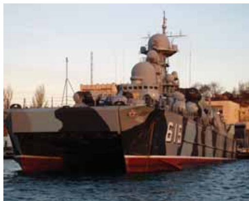
Εικόνα 6: Η Ρωσική κορβέτα τεχνολογίας SES, κλάσης Bora.
