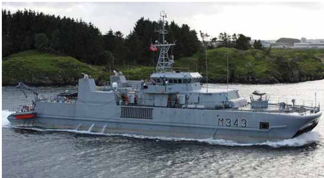
Εικόνα 13: Το Νορβηγικό πλοίο ναρκοπολέμου τεχνολογίας SES, Oksoy.
