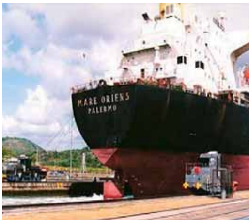
Σχήμα 10: Ελκτικές μηχανές για την προώθηση των πλοίων στις δεξαμενές 50
