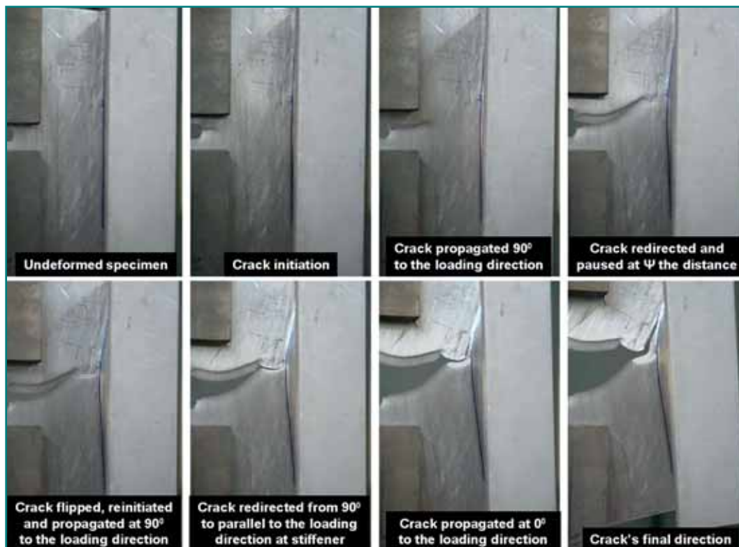
Σχήμα 9. Βηματική διάδοση της ρηγμάτωσης στο εξελασμένο τύπου-T ενισχυμένο CTEB δοκίμιο (κάτοψη), στο οποίο δεν υπάρχει υλικό πίσω από το ενισχυτικό, παρουσιάζοντας τα φαινόμενα που παρατηρήθηκαν: διάδοση της ρηγμάτωσης με γωνία 30 μοιρών σε σχέση με την φόρτιση, παύση, αλλαγή γωνίας διάδοσης, επανεκκίνηση και αλλαγή κατεύθυνσης σε 90 μοίρες σε σχέση με την φόρτιση, και διάδοση παράλληλα με την φόρτιση.
