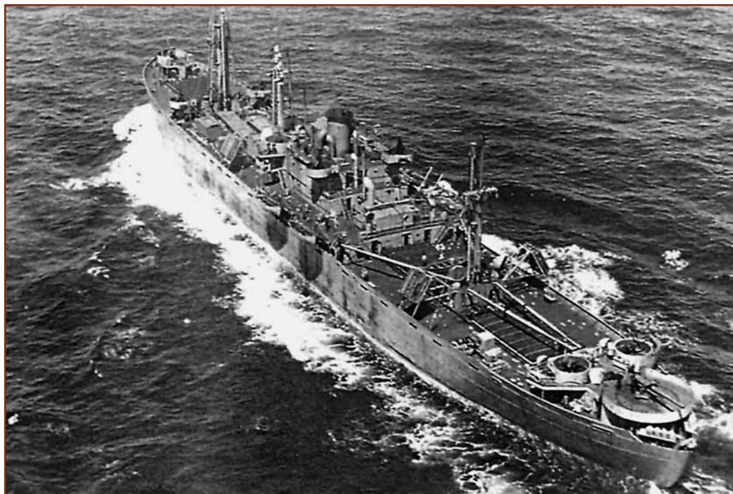
Το λίμπερτυ ΚΕΡΚΥΡΑ στον πόλεμο με το όνομα WILLIAM GRAYSON, με τον πολεμικό εξοπλισμό. 2 πυροβόλα 3 και 8 αντιαεροπορικά πυροβόλα.
