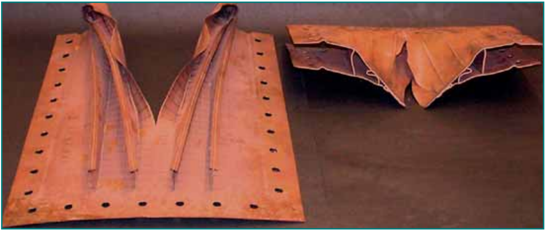
Σχήμα 2. Έρευνα σε βεβλαμένα ή θραυσμένα κατασκευαστικά μοντέλα μικρής κλίμακας που υποβλήθηκαν σε τοπικό εγκάρσιο φορτίο παρουσιάζοντας την διάδοση της ρηγμάτωσης μεταξύ και παράλληλα με τα ενισχυτικά για μονή (αριστερά) και διπλή (δεξιά) ενισχυμένη κατασκευαστική διάταξη.
